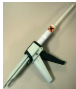
Pistolet et canule de mélange et d'application de la colle.
