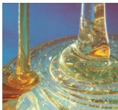
Résine bicomposant : résine et durcisseur.
