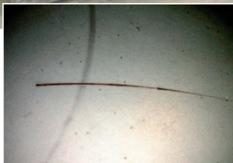
Le ripage provoque une usure par rayure profonde.
