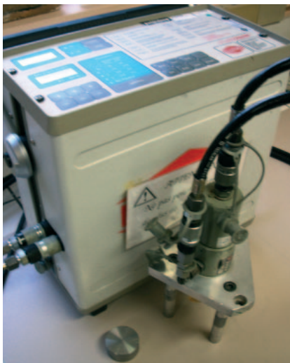
Appareil d'essai et de mesure de cohésion par traction direct.
