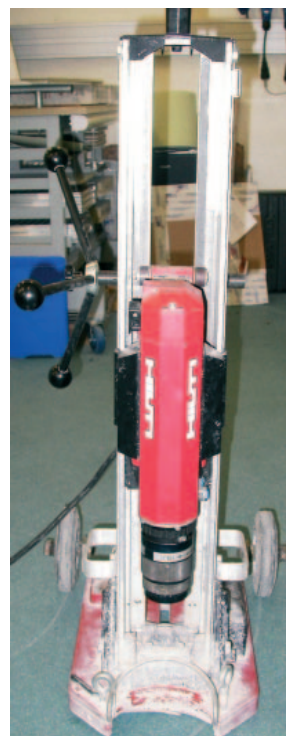
Appareil d'essai et de mesure de cohésion par traction direct.
